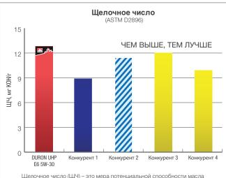
Щелочное число (ЩЧ) – это мера потенциальной способности масла нейтрализовать вредные кислоты, которые образуются в процессе сгорания. Способность противостоять вредным кислотам помогает уменьшить коррозию, вызываемую кислотами. Масло DURON UHP Е6 имеет значительно более высокое щелочное число, которое превышает показатели всех конкурирующих продуктов, участвующих в испытаниях.
